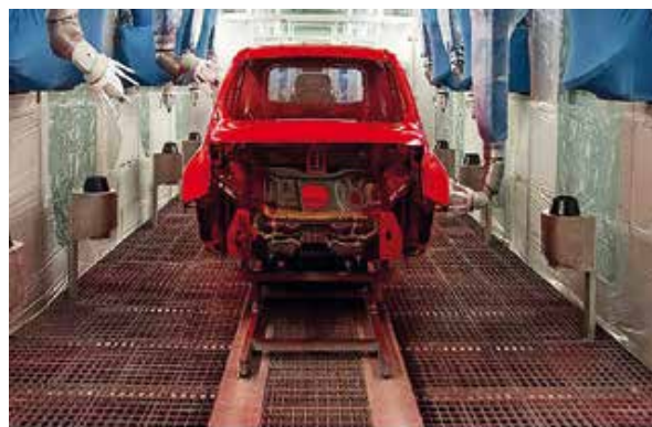
Fig. 6 - Cabine de pintura robotizada
